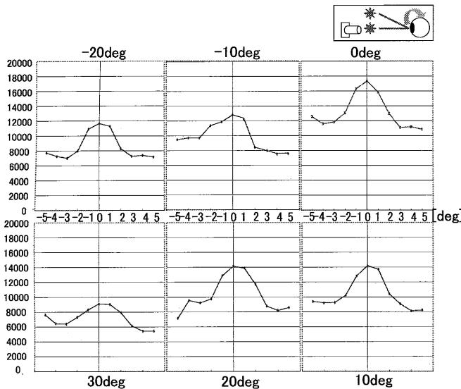
図 9 視線方向による再帰反射特性の変化
