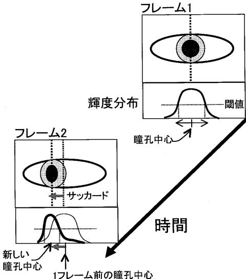
図 11 サッカード検出のための画像処理
