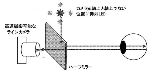
図 6 提案する計測原理のシステム構成
