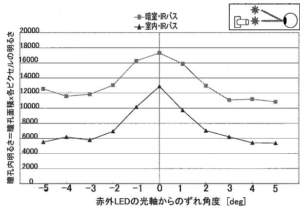
図 8 注視点 0deg (暗室・室内条件), 赤外 LED の位置を変えたときの再帰反射特性の変化
