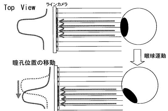
図 4 眼球運動による瞳孔位置の移動
