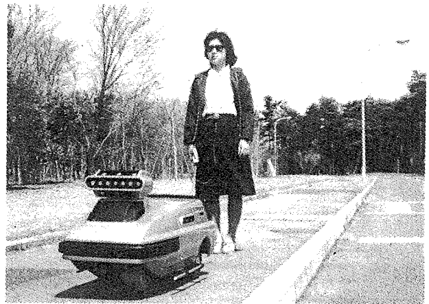
写真1 盲導犬ロボット MELDOG MARK IV
