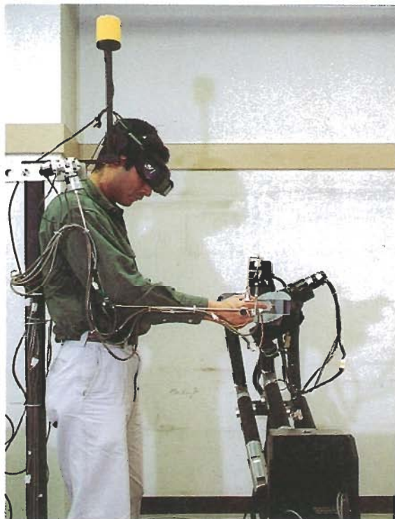
図2 視触覚形状提示システム 見たところを触れることがバーチャルリアリティの特徴の一つである。写真の装置はメカニカルインピーダンスを制御できる6自由度のパンタグラフ機構の先に様々な形状を近似できる形状近似デバイスを搭載したハプティクスグラフィックスシステムで、質量や弾性あるいは粘性を感じつつ物体の形状を綾や頂点も含めて触覚と視覚で体験できる (10) 。
