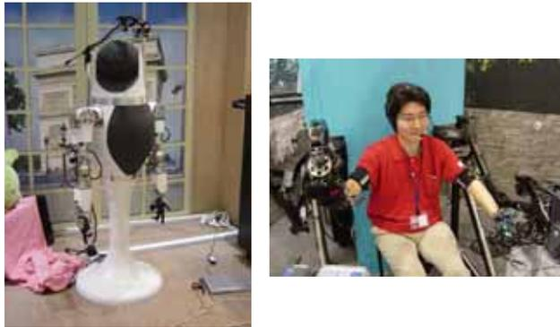
図3 相互テレグジスタンスロボット TELESAR (左)スレーブロボット(右)マスターコクピット
