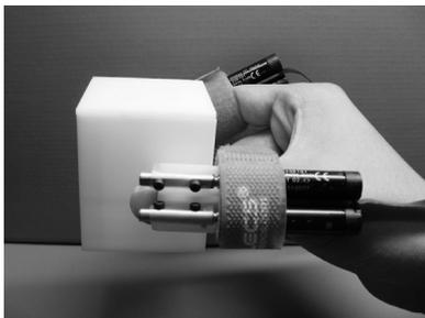
図9 軽量な立方体を把持した状態でプロトタイプデバイスにより重量感覚を提示する様子
