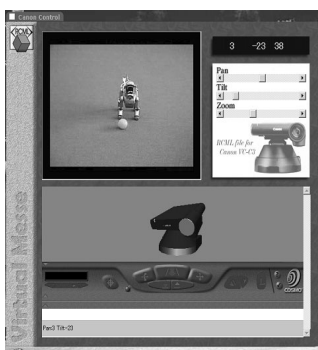
図 7 パン・チルトカメラ制御時の画面 Fig. 7 Control panel of the pan/tilt camera
