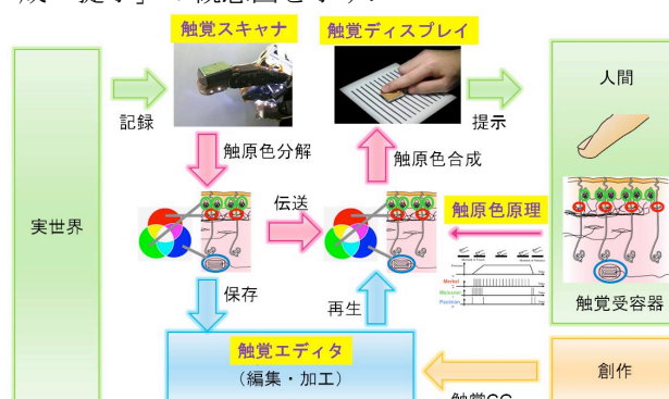
図2 触覚情報の「計測」「伝送」「提示」
